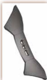
*Soc réversible 55x15x400. Adaptable sur dent Chisel monolame et Chisel bilame. **Permet de limiter la résistance à la traction tout en permettant un ameublissement.***
