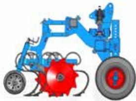
Bras de liaison réglable si option à l'arrière de l'élément bineur: Poutre P3 et P4
