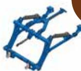
*Pour réduire le porte à faux du semoir sur le tracteur*
