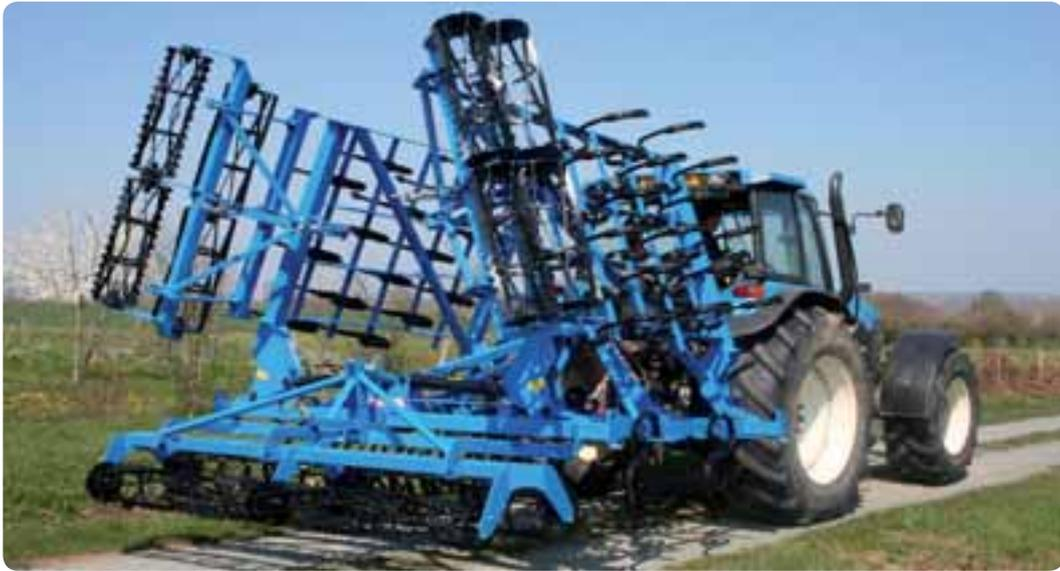
*Châssis monobloc entièrement mécano-soudé*
