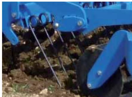
**Réguler et niveler le flux de terre, recouvre l'ouverture de la dernière rangée de dents**
