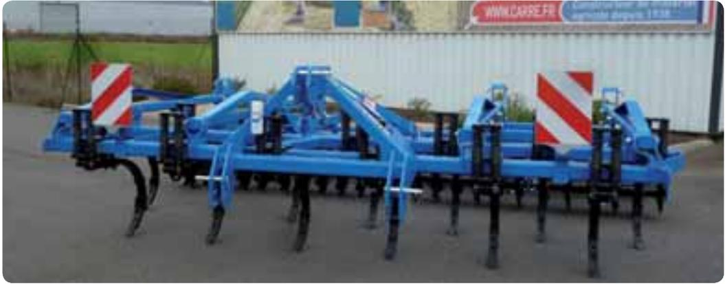
Châssis monobloc entièrement mécano-soudé
